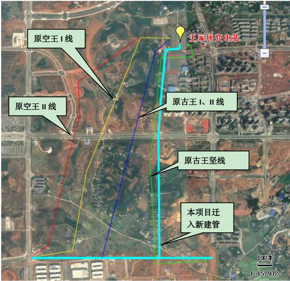
图 1-1 原线路走向及与新建管廊相对位置示意图
