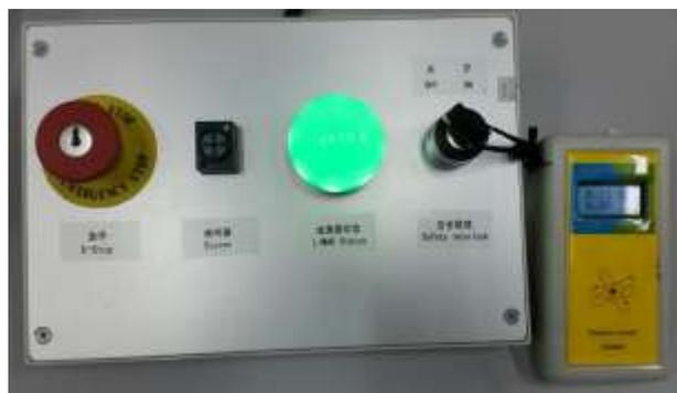
图 10-3 系统控制台上安全联锁开关
