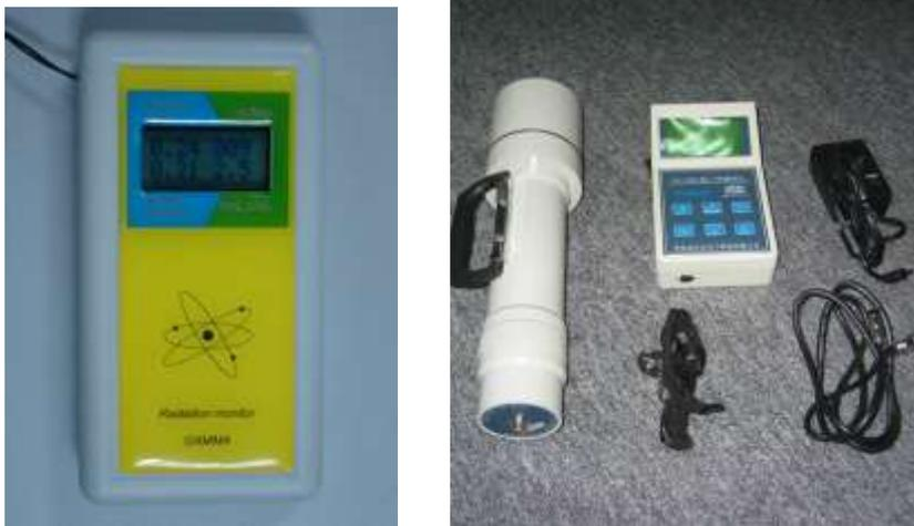
图 10-5 个人剂量报警仪和环境 X、 $\gamma$  剂量率仪
