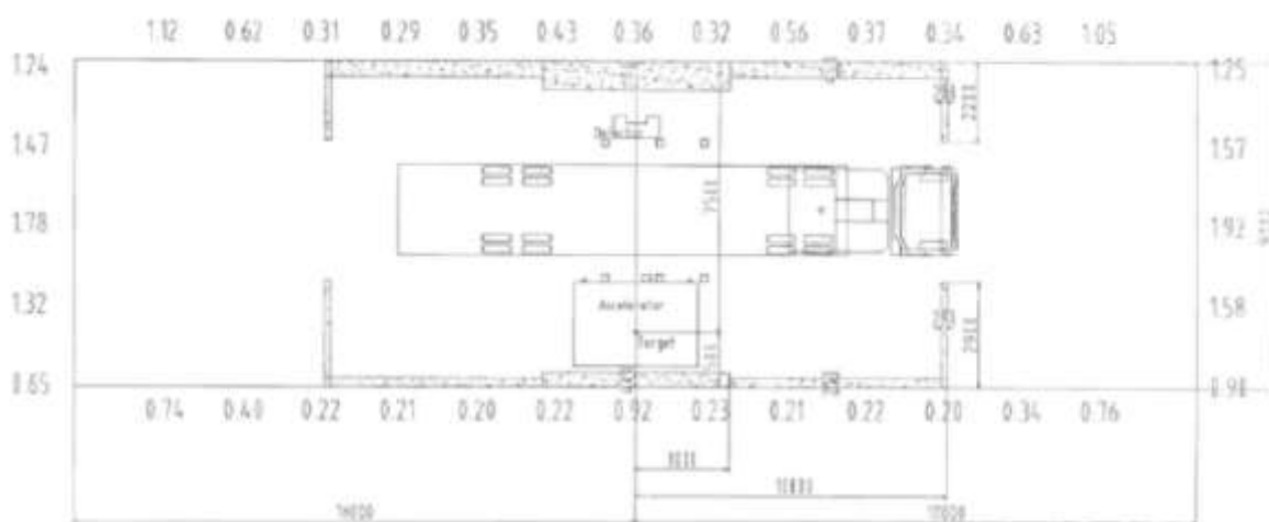
图 11-1 辐射防护边界剂量率检测点及检测值（单位 \mu Gy/h）
