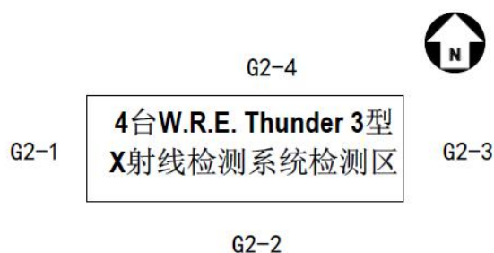
图 11-2 4 台 W.R.E.Thunder 3 型 X 射线检测系统监测布点示意图
