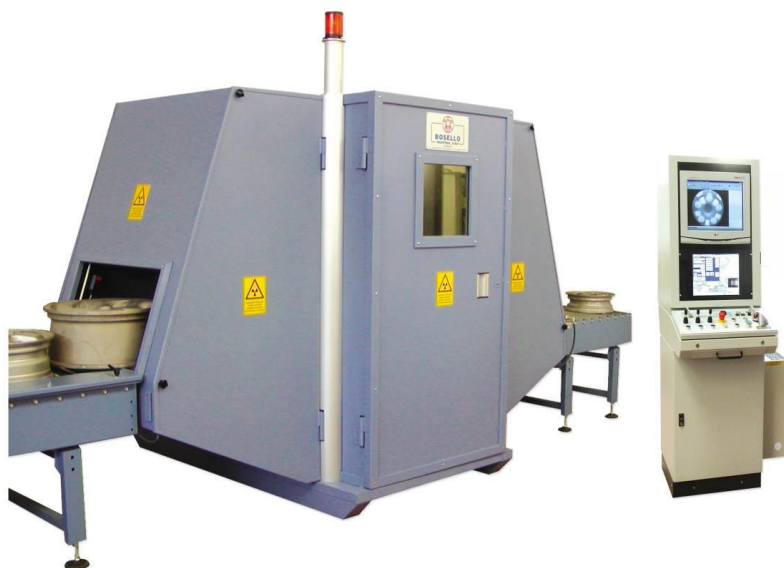
图 9-2 W.R.E. Thunder 3 型 X 射线检测系统设备图
